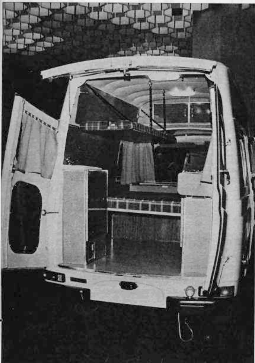
Sobre base Sava también se han realizado algunos prototipos. El que mostramos en la fotografía tiene una capacidad para cuatro personas, e incluye fregadero y cocina a gas, amén de dos armarios roperos.
