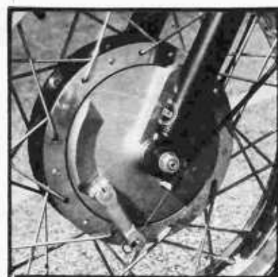
Freno de tambor en ambas ruedas, mandado mecánicamente. La superficie de frenado es correcta para las prestaciones y peso de la Strada.
