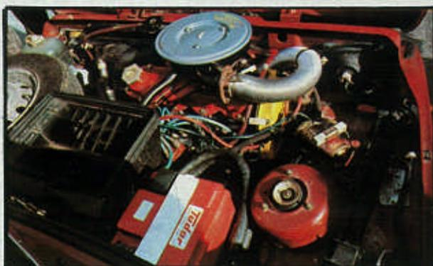
Aspecto del motor 1.300. Muchos tubos de goma han debido ser reemplazados para evitar que sean corroídos por el alcohol.
