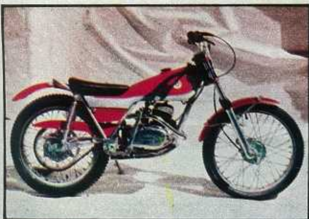
BULTACO CHISPA (CICLOMOTOR DE MONTAÑA, NIÑO). Motor monocilíndrico de dos tiempos y 47,6 cc. (38x43). Compresión: 8,5:1. Potencia: 3 CV, a 6.000 revoluciones-minuto. Caja de cambios: de tres marchas. Peso: 34 kilos. Depósito: 3,5 litros. Velocidad máxima: 30 kilómetros-hora.
