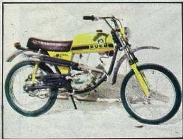
PUCH MINICROSS MC-50. Monocilíndrica dos tiempos y 48,8 cc. (38x43). Compresión: 11:1. Potencia: 4 CV, a 5.500 revoluciones-minuto. Cambio de cuatro marchas. Peso: 55 kilos. Depósito: 6 litros. Precio: 20.000 pesetas.
