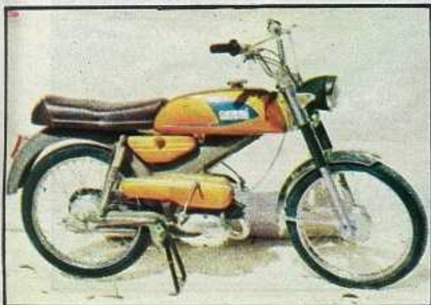
DERBI ANTORCHA CAMPEONA. Monocilíndrica de dos tiempos y 48,7 cc. (38x43). Compresión: 9:1. Potencia: 2,5 CV, a 5.700 revoluciones-minuto. Cambio de tres marchas. Peso: 54 kilos. Depósito: 6 litros. Precio: 18.500 pesetas.
