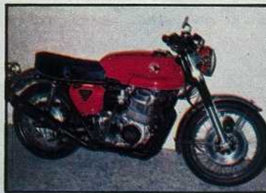
JAPAUTO. Motor de cuatro cilindros en línea, transversales, con un árbol de levas en cabeza. Cuatro tiempos. Cilindrada: 969 cc. (70x63). Potencia: 80 CV, a 8.000 revoluciones-minuto. Caja de cambios de cinco marchas. Peso: 220 kilos. Depósito: 24 litros. Velocidad máxima: 225 kilómetros-hora. Precio: 450.000 pesetas.
