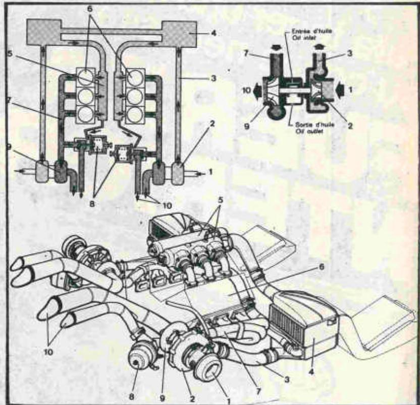
Esquema de un motor turbo: 1) Toma de aire; 2) Compresor; 3) Aire comprimido; 4) Refrigerador del aire comprimido; 5) Colector de admisión; 6) Cilindros; 7) Gas de escape; 8) Válvulas de regulación de la presión de gases en la turbina; 9) Turbina; 10) Salida de los gases de escape.
