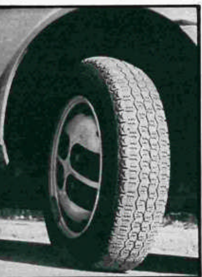
El dibujo de los neumáticos es pieza fundamental a la hora de valorar los problemas de adherencia del automóvil. Como mínimo, la profundidad de la banda de rodadura debe ser superior a los 5 mm., de manera que pueda evacuar el agua sin producir «aqua planing».
