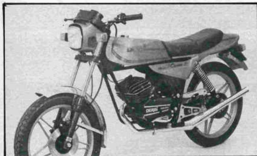
Derbi Sport 125 Coppa, modelo equipado con motor monocilíndrico de dos tiempos y cambio de seis marchas. Los frenos son de disco en ambas ruedas, con mando hidráulico (doble disco en la rueda delantera), y viene equipada con llantas de aleación.
