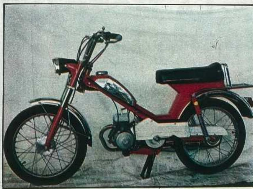
**CANGURITO 49.**—Los ciclomotores automáticos tienen gran prestigio, sobre todo entre el sexo débil. El Cangurito 49 es un ciclomotor construido en Sevilla por Motorhispania, fabricante de los famosos productos Moto-Guzzi. Tiene una cilindrada de 49 y monta transmisión automática. Velocidad máxima: 40 kilómetros por hora. Precio: 22.000 pesetas, aproximadamente.
