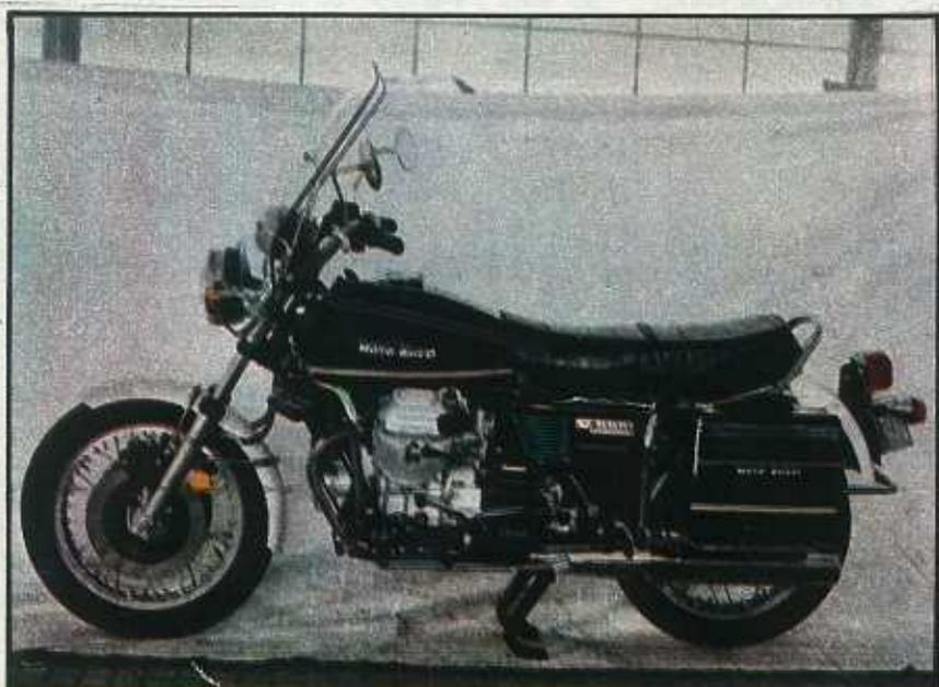
**GUZZI CONVERT 1000.**—Podemos asegurar que se trata de un Rolls-royce de la moto. Cambio automático, más de 80 CV de potencia, tres frenos de disco accionados por un solo mando con el consecuente repartidor, etc. En definitiva, una máquina segura, cómoda y confortable y cuyo precio es inferior a las 400.000 pesetas.
