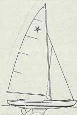
11 Star. El monotipo de bulbo y en V, diseñado en 1911 por el arquitecto estadounidense William Gardner, tiene las siguientes características principales: eslora total, unos 6,921 m.; manga, unos 1,730 m.; peso, 662 kg.; superficie de las velas, unos 26,00 m 2 ; tripulación de regatas: dos; construcción en madera o plástico. La letra Z delante del número representa la nacionalidad: en este caso, Suiza.
