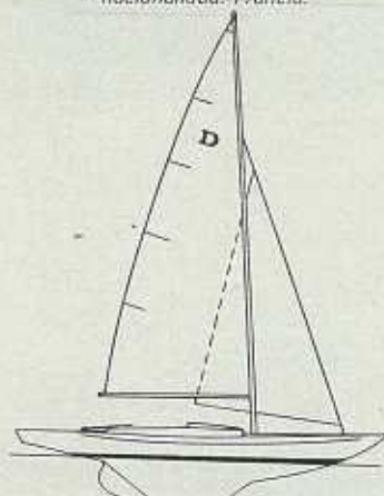
10 Dragón. El Dragón, diseñado en 1929 por el noruego Johan Anker, es un monotipo con las siguientes características principales: eslora total: 8,900 m.; manga: 1,968 m.; calado: 1,200 metros; peso: 1.700 kg.; superficie de las velas: 22,00 m 2 ; tripulación de regatas: tres; construcción en madera. Las letras colocadas antes del número que figuran en la vela indica la nacionalidad; en este caso se trata de un participante de la Unión Soviética.
