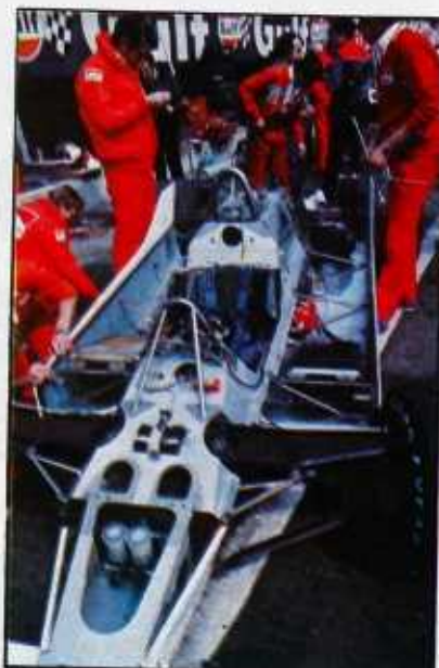
Un «coche ala» (McLaren M.29) con las tripas al aire. Tan sólo las faldillas tendrían que desaparecer.
