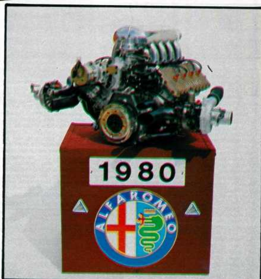
Aspecto del nuevo motor V-8 1.500 Turbo, todavía en fase de puesta a punto. En el banco parece que ha llegado a los 580 CV, cifra extraordinaria.
