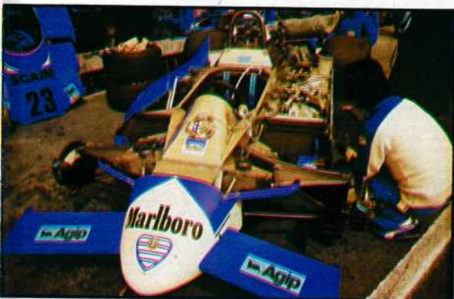
El modelo 179 evolucionó mucho durante la temporada gracias a las indicaciones del malogrado Patrick Depailler. La carrocería fue diseñada en colaboración con una empresa aeronáutica francesa.
